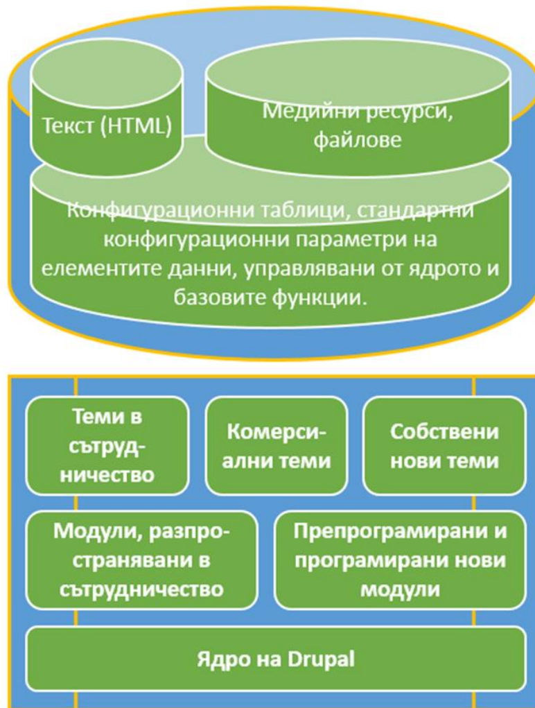
Фиг. 2.4. Двуслойна архитектура на програмния код и данните
